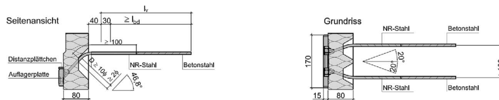
Abb. 7: Querkräftestäbe 2 × Ø 8 mm inkl. Auflagerplatte
