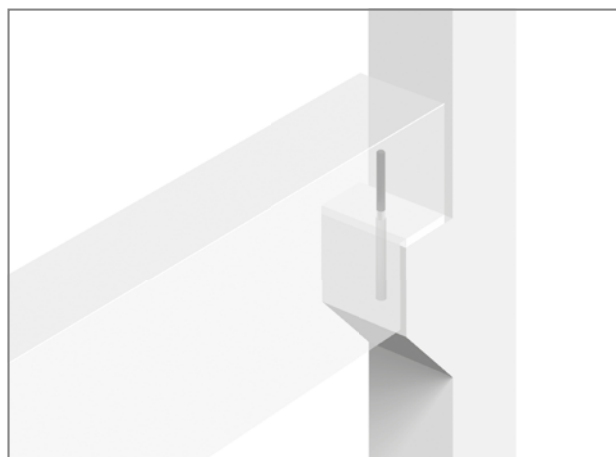
Fig. 16: Schöck Dorn: fissaggio di una trave in legno su una mensola
