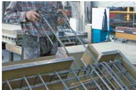
Abb. 1: Stiege schalen. Typ Z Part T einsetzen
