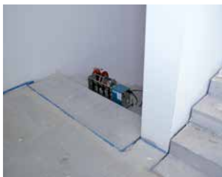
Entkoppeltes Podest und Stiege mit Norm-Hammerwerk
