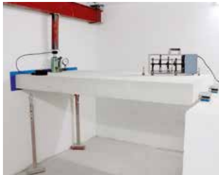
Prüfaufbau mit Tronsole® Typ Z und Typ L für Podestmessung.
