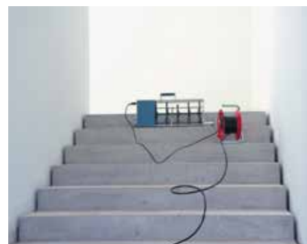
Stiege mit ausreichender Luftfuge und Norm-Hammerwerk
