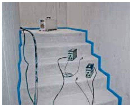
Eingebaute Stiege wird mit Norm-Hammerwerk angeregt.
