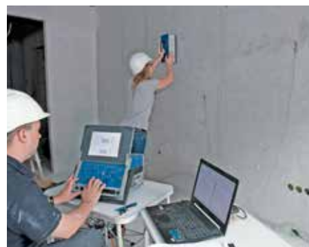
Messung der Körperschall-Nachhallzeit der Stiegenhauswand.
