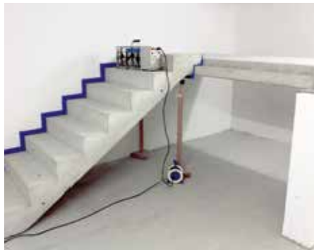
Prüfaufbau mit Tronsole® Typ F und Typ L für Laufmessung.
