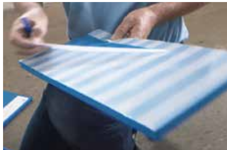
Abb. 7: Typ L Klebefolie entfernen und aufkleben
