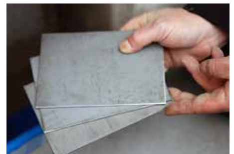
Abb. 11: Druckfeste Unterlegplatten für Höhenausgleich bereithalten
