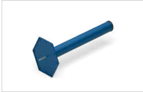
Schöck Stacon® type LD / F-LD Part P Gaine en plastique pour dilatation longitudinale. La platine plastique à clouer permet une fixation simple au coffrage
