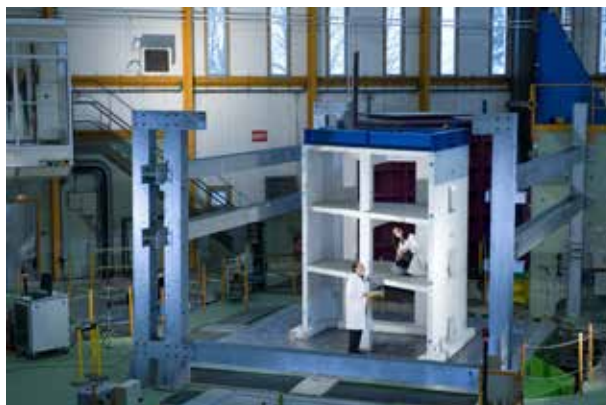
De Azalée triltafel in het Laboratorium voor Seismische Mechanische Studies in Frankrijk
