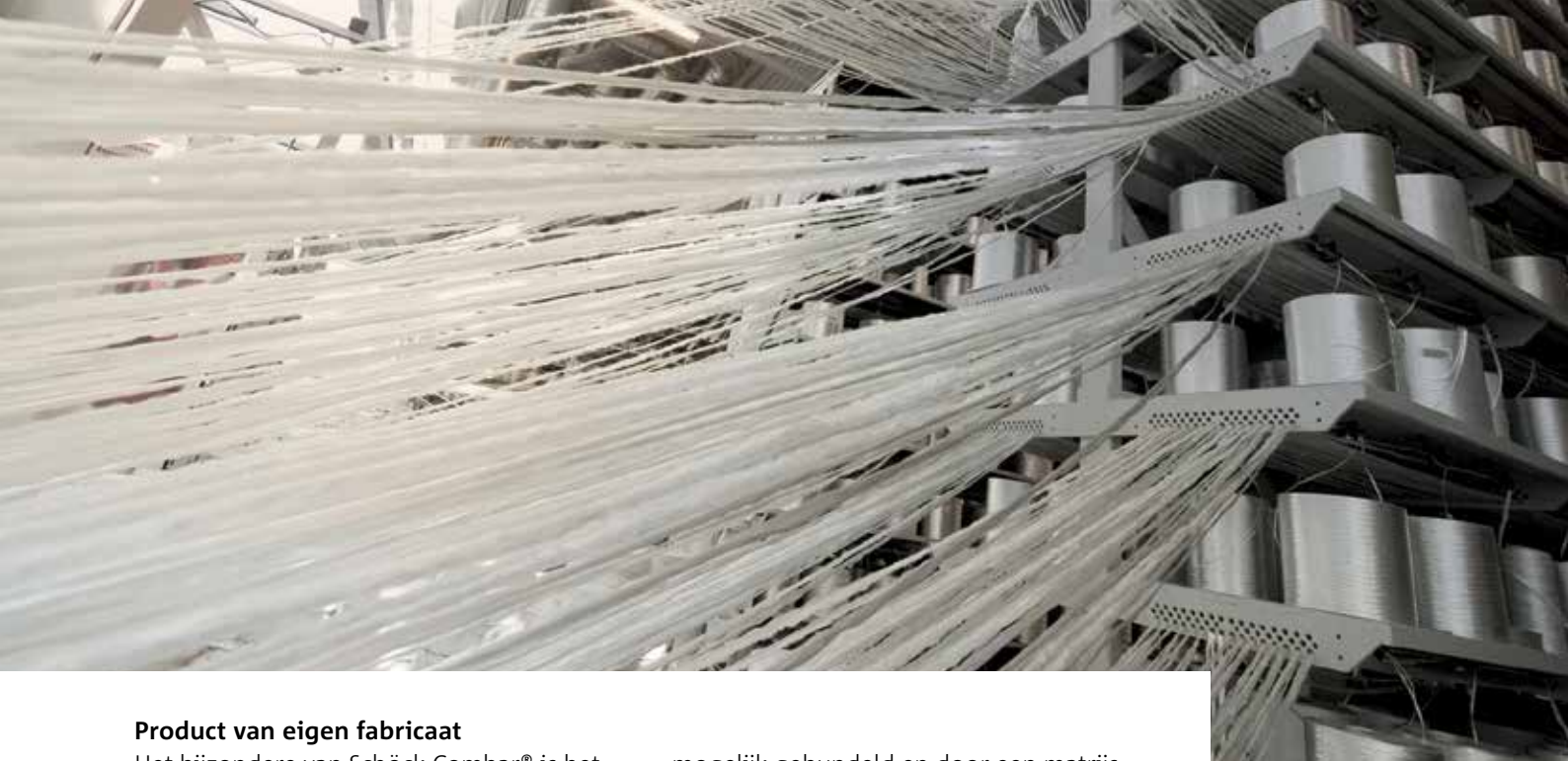
Rovingspoelen en vezelgeleiding bij pultrusie (©Fiberline Composites A/S)
