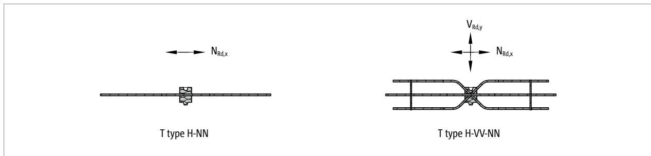
Fig. 137: Schöck Isokorb® T type H: Type selection
