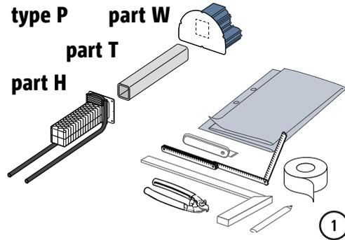
**⚠ WARNING** Gefahr durch abstürzendes Bauteil bei unvollständigem Einbau! Es müssen alle Parts Tronsole® Typ P (Parts W + T + H) verbaut werden.
