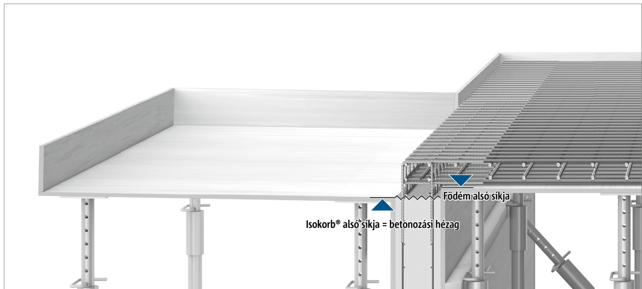
Ábra 32: Schöck Isokorb® T KL típus: zsaluzás és vasalás előkészítése a betonozáshoz. Betonozási munkahézag a falnál= erkély zsaluzás alsó síkja!
