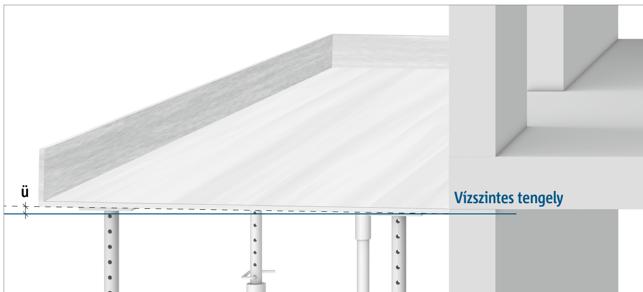
Ábra 13: A zsaluzat túlemelése a betonozás során
