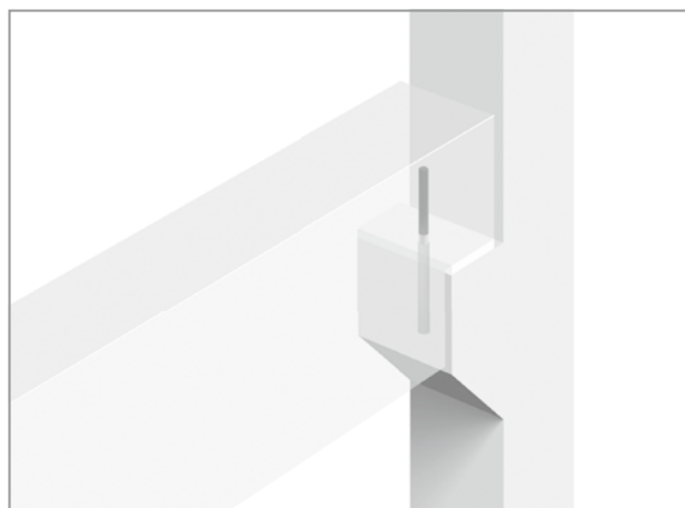
Ábra 16: Schöck Stacon®: gerenda rögzítése tartókonzorra
