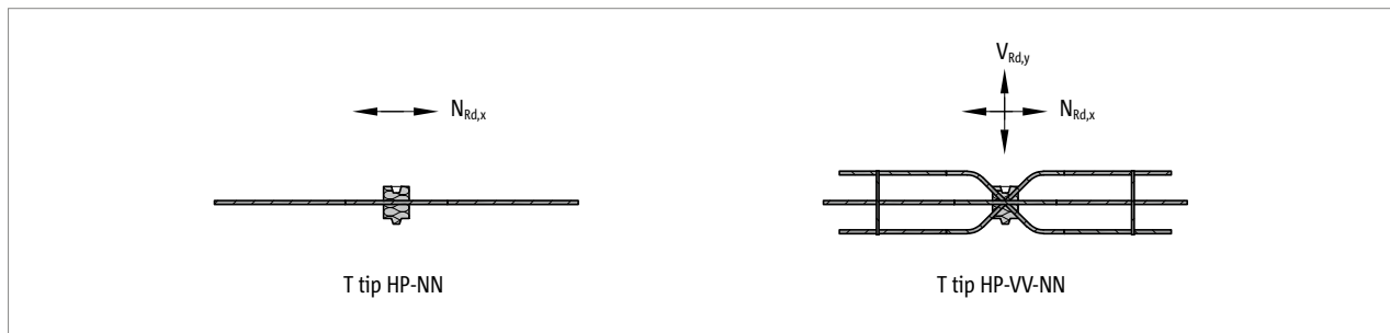
Slika 19: Schöck Isokorb® T tip HP: Izbor tipa
