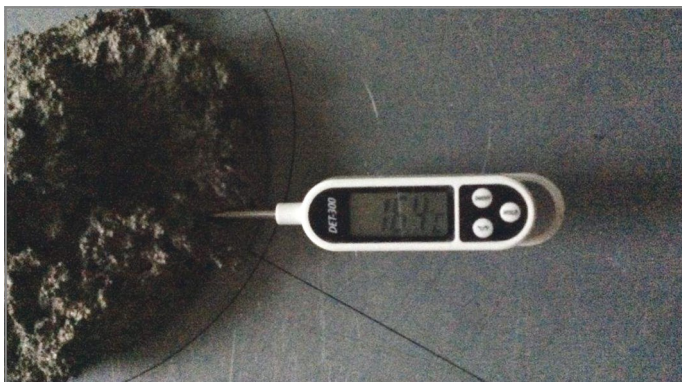
Abb. 60: Temperatur messen, fertige Mischung
