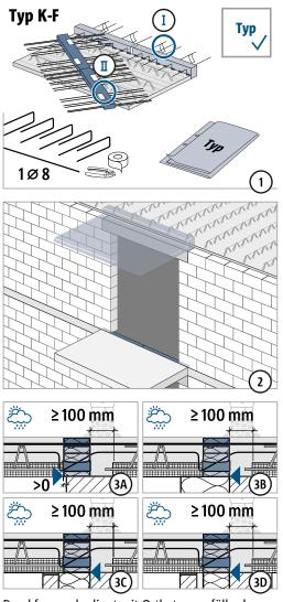
Druckfuge unbedingt mit Ortbeton verfüllen! Fugenbreite ≥ 100 mm.
