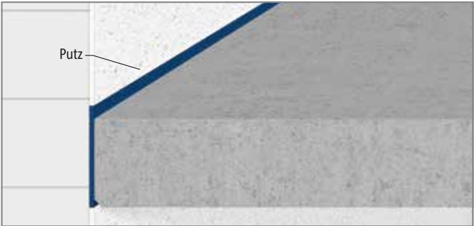
Abb. 30: Wandputz nur auf die Fugenplatte führen, dabei darauf achten, dass keine starre Verbindung zum Treppenlauf oder Podest entsteht
