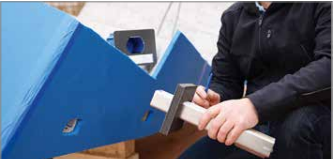
Abb. 73: Tragelement bei Laufhülse positionieren
