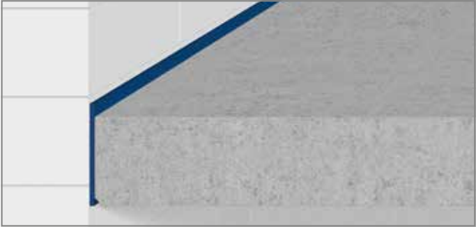
Abb. 29: Die Fugenplatte Tronsole® Typ L wird mit einen Überstand von 30–40 mm, bzw. 10 mm über OK Belag, über Rohstufe/Podest ausgeführt
