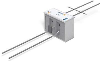
*Schöck Isokorb XT Typ QL mit Drucklager HTE-Compact und 120 mm Dämmkörperdicke ist ein tragendes Wärmedämmelement zur Querkraftübertragung bei Balkonen auf Stützen, Loggien sowie bei punktuell hohen Querkraften.*
