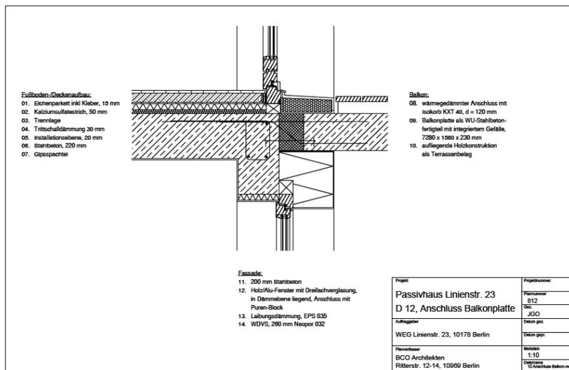
Zertifiziert vom Passivhausinstitut: Als tragendes Wärmedämmelement sorgt der Schöck Isokorb KKT für einen sicheren Balkonanschluss, der den Kriterien einer „Wärmebrückenarmen Konstruktion“ gerecht wird.
