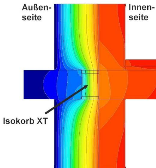
*Ohne kritische Wärmebrücke: Die Wärmebrückenberechnung zeigt, wie der Balkonanschluss mit dem Schöck Isokorb KXT als wärmebrückenarme Konstruktion realisiert wird.*
