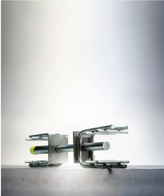
*Der Schwerlastdorn Schöck Stacon Typ SLD verbindet Betonbauteile über Dehnfugen hinweg und nimmt Querkräfte zuverlässig auf. Das neue Bemessungsmodell ermöglicht die besonders kompakte Ausführung. Foto: Schöck Bauteile GmbH*
