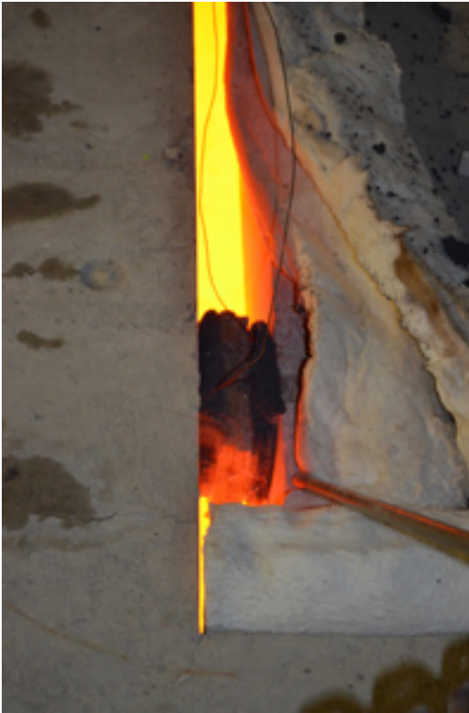
Bei Versuchen wurde eine Standsicherheit von über 120 Minuten ermittelt – damit erreichte Stacon Typ SLD die Feuerwiderstandsklasse R 120. Foto: Schöck Bauteile GmbH
