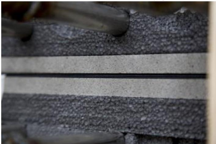
*Die Stirnunter- und Stirnoberseite des Polystyrol-Dämmkörpers sind mit Streifen einer feuerfesten, zementgebundenen Fibersilikatplatte eingefasst und mit einem intumiszierenden Band ausgerüstet.*
