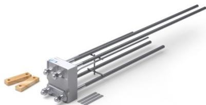
*Um Wärmebrücken an den Balkonen zu minimieren und Schimmelpilzbildung im Innenbereich zu verhindern, kam das Wärmedämmelement Isokorb Typ KS von Schöck zum Einsatz. Das tragende Wärmedämmelement für den Anschluss frei auskragender Stahlträger an Stahlbetondecken erlaubt hohe Tragfähigkeiten, lässt bei der Balkongestaltung viel Freiraum zu und bietet eine statisch hervorragende Lösung.*
