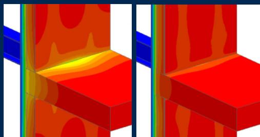
**GAUCHE :** Raccordement structurel standard non isolé. La température extérieure s'infiltré (jaune).
