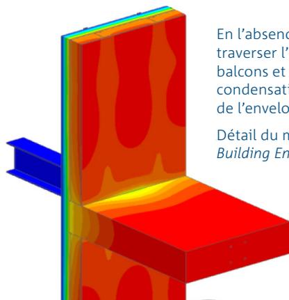
En l'absence de rupture thermique, la chaleur et le froid peuvent traverser l'enveloppe du bâtiment au niveau des raccordements des balcons et des auvents, causant des problèmes d'humidité tels que la condensation et la moisissure, et réduisant la performance thermique de l'enveloppe du bâtiment.
