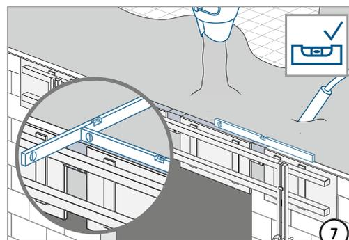
**!** Vérification après le décoffrage : les entretoises, les blocs en bois et les écrous fournis doivent être fixés en sécurité.
