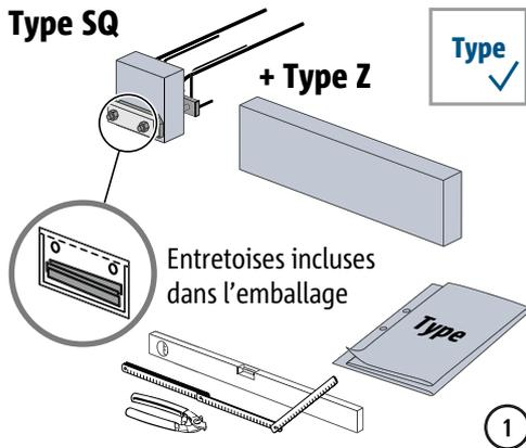
**!** Vérification : les entretoises, les blocs en bois et les écrous fournis doivent être fixés en sécurité.
