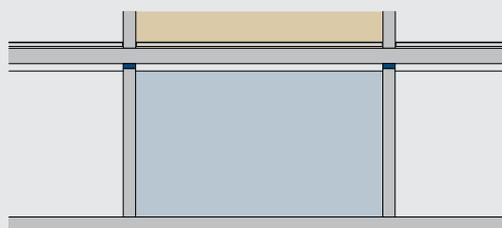
Isolamento sotto solaio garage sotterraneo / cantina
