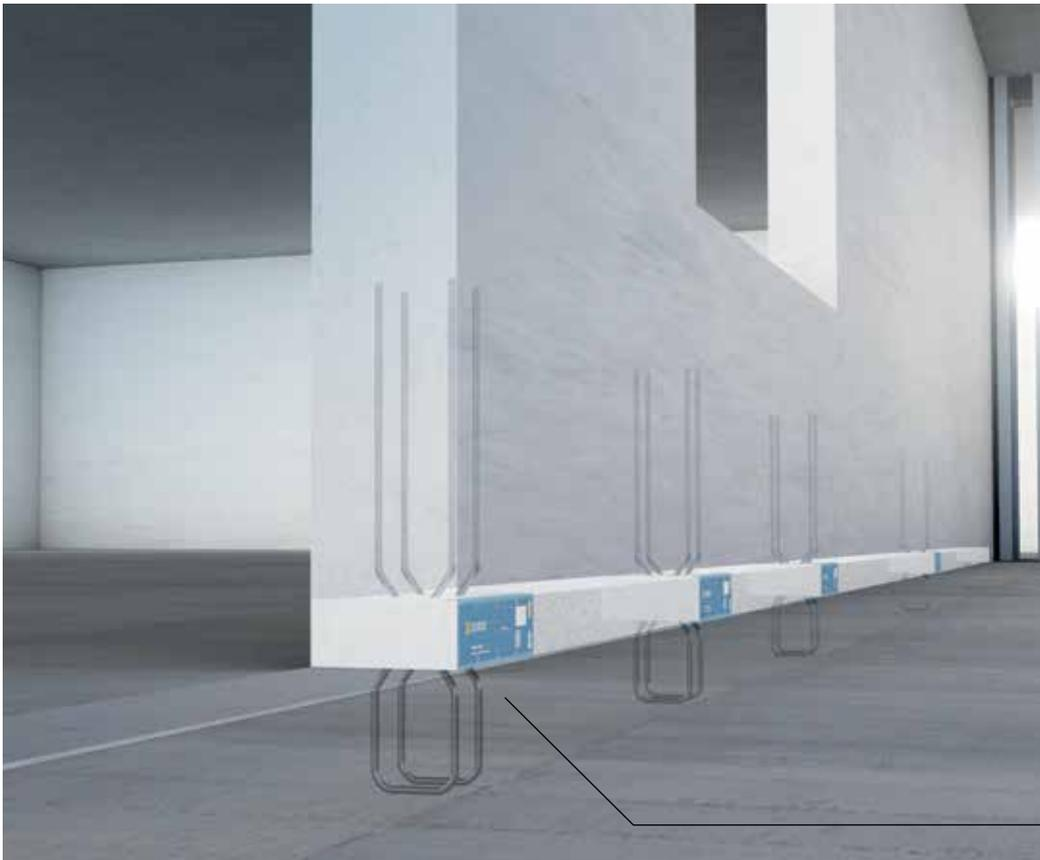
La conformazione del raccordo consente di evitare l'instaurarsi di fenomeni di rotazione e instabilità, rendendo sicuro il calcolo.
