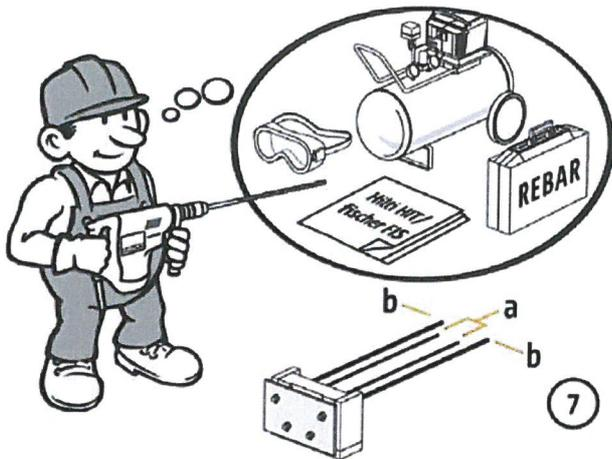
Das Einkleben des Schöck Isokorb® in die Bestandsdecke ist mit einem Injektionssystem gemäß Abschn. 2.1.2 vorzunehmen. Die Handhabung des Injektionssystems ist der ETA und der zugehörigen allgemeinen bauaufsichtlichen Zulassung des entsprechenden Injektionssystems zu entnehmen.
