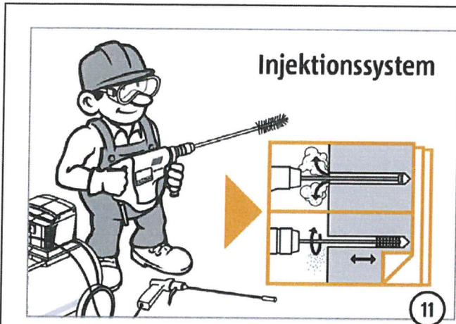
Entsprechend den technischen Anweisungen des entsprechenden Injektionssystems muss jedes Bohrloch gereinigt werden.
