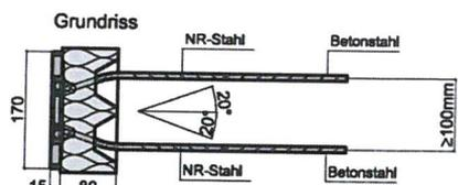
Abb. 7a bis 7b: Querkraftstäbe 2 Ø 8 inkl. Auflagerplatte
