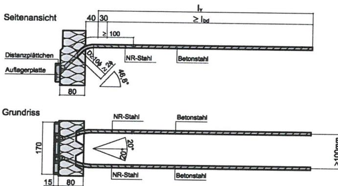
Abb. 13a bis 13b: Querkraftstäbe 2 Ø  $\phi$  inkl. Auflagerplatte
