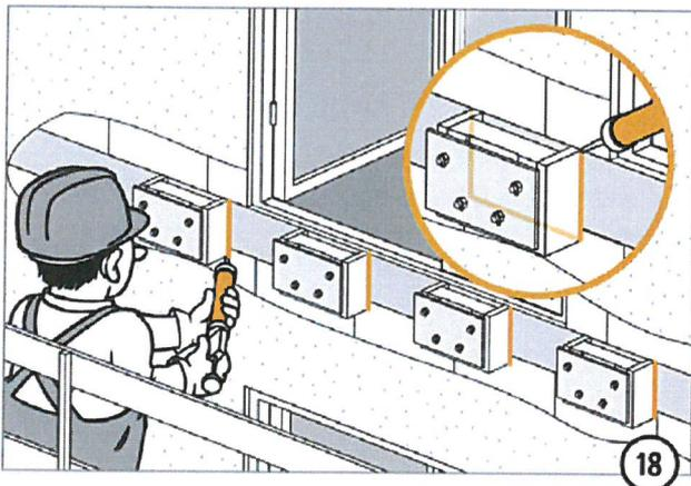
Der Schöck Isokorb® ist in das Injektionssystem einzusetzen. Es ist darauf zu achten, dass der Styroporschalungskörper bündig an der Bestandsdecke anschließt.
