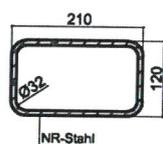
Abb. 8: geschlossener Bügel 1 Ø 8
