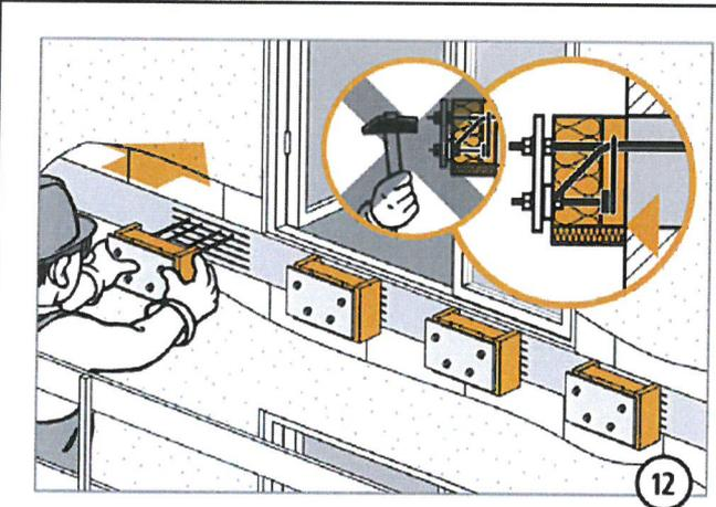
Nach der Bohrlochreinigung erfolgt der trockene Einbau des Schöck Isokorb® zu Kontrollzwecken. Der Isokorb® muss ohne großen mechanischen Kraftaufwand einsetzbar sein.
