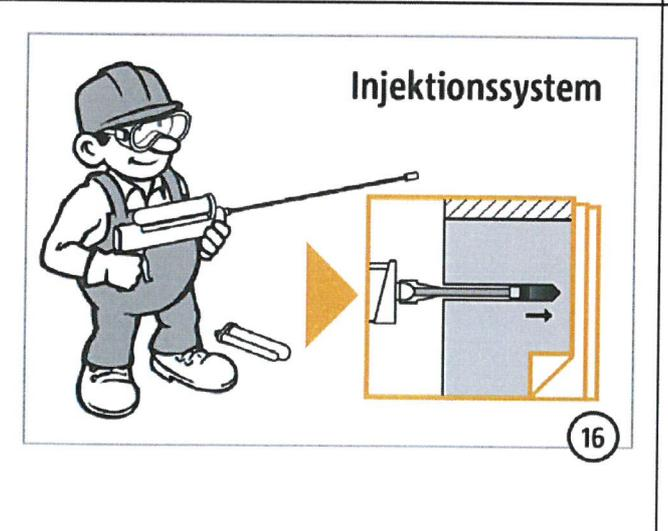
Das Bohrloch muss luftblasenfrei mit Injektionsmörtel nach der Setzanweisung des entsprechenden Injektionssystems verfüllt werden.
