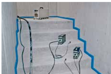
Eingebaute Treppe wird mit Norm-Hammerwerk angeregt.
