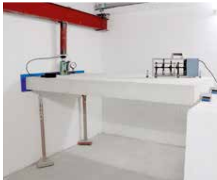
Prüfaufbau mit Tronsole® Typ Z und Typ L für Podestmessung.
