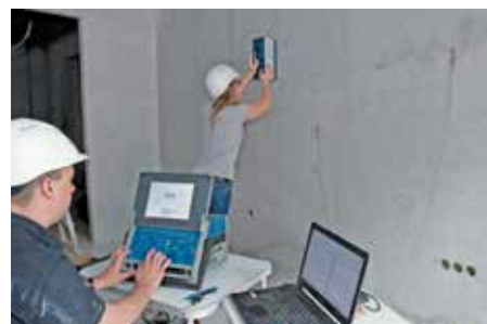
Messung der Körperschall-Nachhallzeit der Treppenhauswand.
