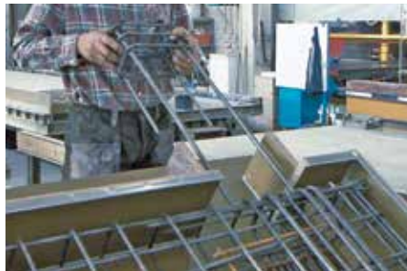
Abb. 1: Treppe schalen; Typ Z Part T einsetzen
