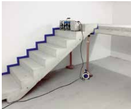
Prüfaufbau mit Tronsole® Typ BZ und Typ L für Laufmessung.
