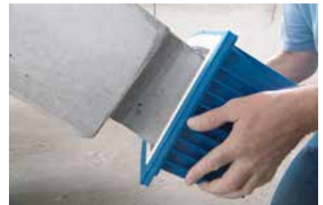
Abb. 5: Typ Z Wandelement zur Kontrolle der Geometrie aufstecken
