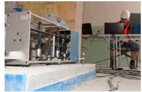
Eingebaute Treppe wird mit Norm-Hammerwerk angeregt.
