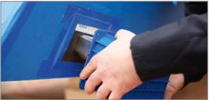
Abb. 81: Wandelement aufsetzen bis Tragelement einrastet
