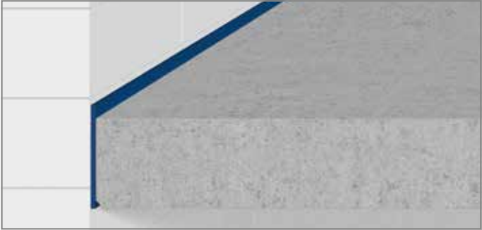
Abb. 31: Die Fugenplatte Tronsole® Typ L wird mit einen Überstand von 30–40 mm, bzw. 10 mm über OK Belag, über Rohstufe/Podest ausgeführt
