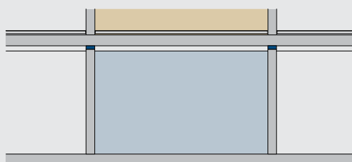
Unterdeckendämmung Tiefgarage / Keller
