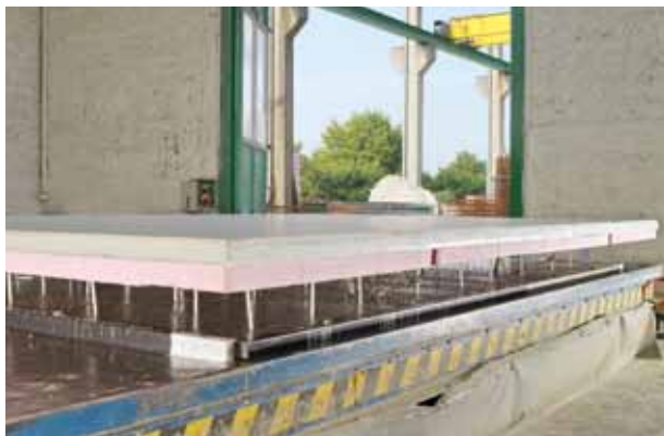
3. Käännä eristetty kuori ja laske se toisen kuoren päälle
