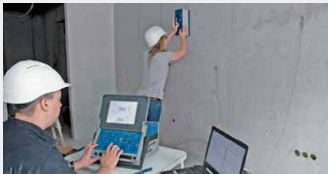
Messung der Körperschall-Nachhallzeit der Stiegenhauswand.
