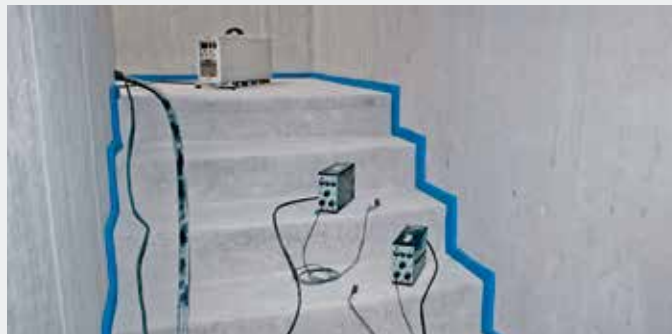
Eingebaute Stiege wird mit Norm-Hammerwerk angeregt.
