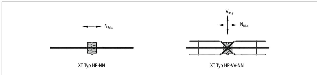
Abb. 48: Schöck Isokorb® XT Typ HP: Typenauswahl
