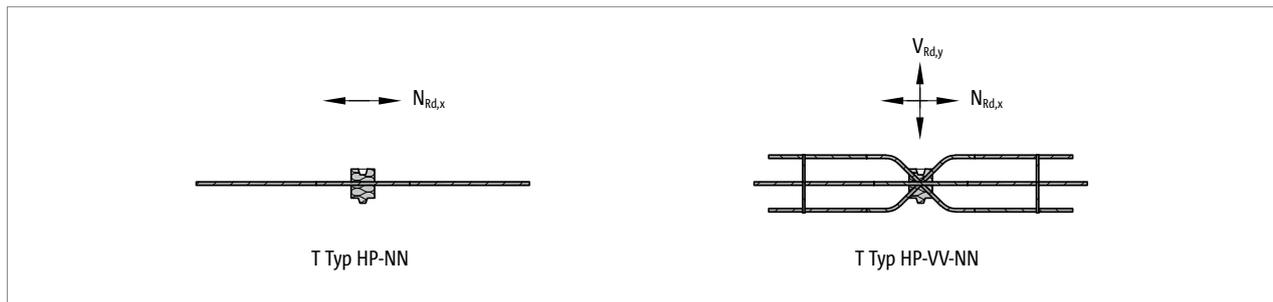
Abb. 19: Schöck Isokorb® T Typ HP: Typenauswahl
