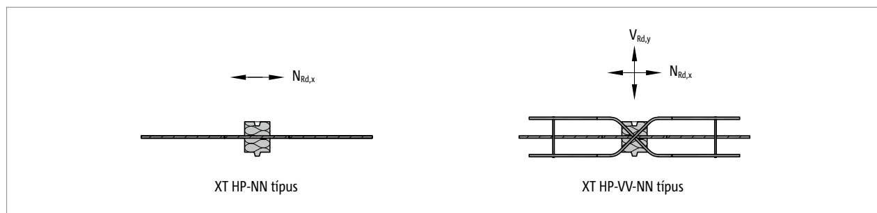
Ábra 43: Schöck Isokorb® XT HP típus: Típus kiválasztása
