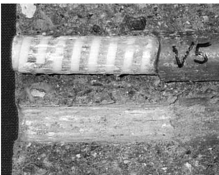
Het speciale oppervlakprofiel van Schöck ComBAR® staven zorgt voor optimale aanhechting van het beton en de staaf.
