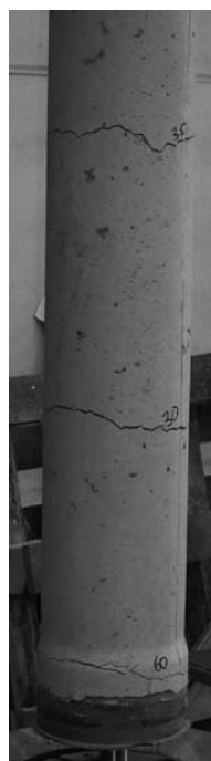
Tweede scheur ( 300 \text{ N/mm}^2 )
